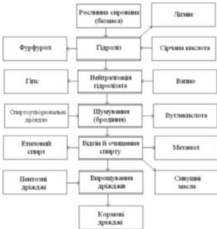
Рис. 4. Схема спиртоводріжджового виробництва при однофазному гідролізі.
