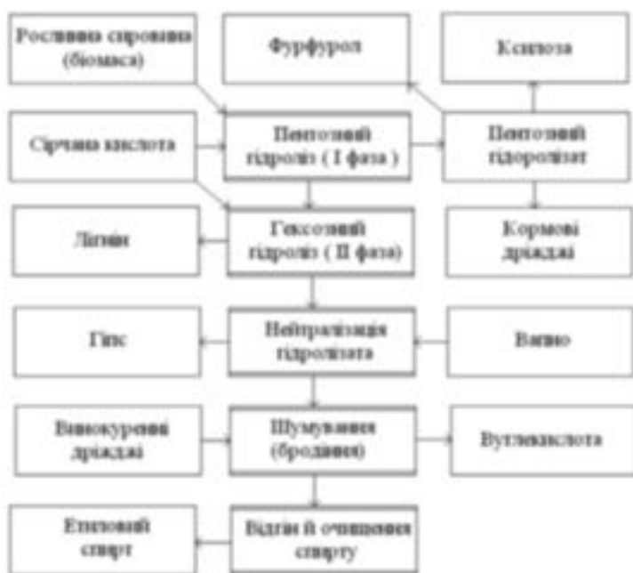
Рис. 1. Схема переробки рослинної сировини, що насичена пентозанами, при двофазному гідролізі.
