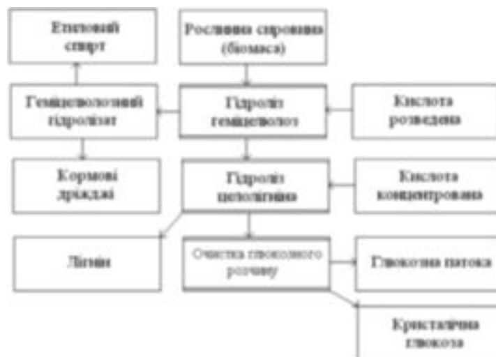
Рис. 2. Схема виробництва кристалічної глюкози з рослинної сировини.
