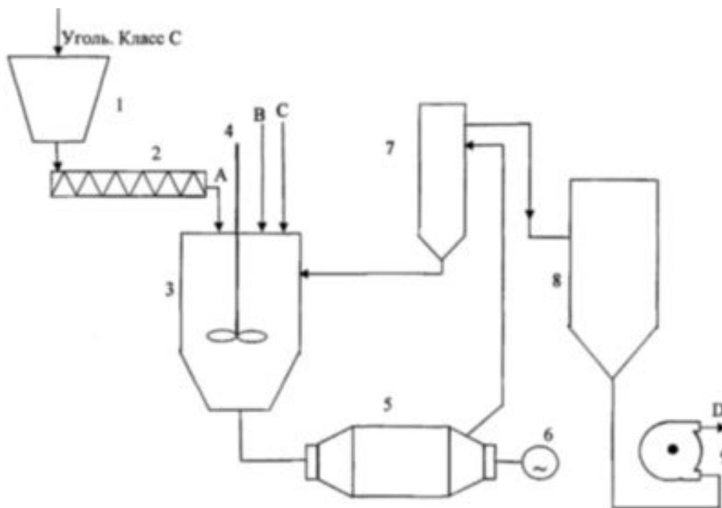
**Рис. 3. Принципиальная схема производства водоугольного топлива [1].**
