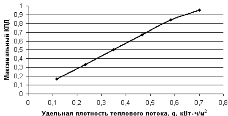
Рис. 3. Изменение коэффициента полезного действия при разных объемных расходах V от 0,5 до 3,0 \text{м}^3/\text{ч} .
