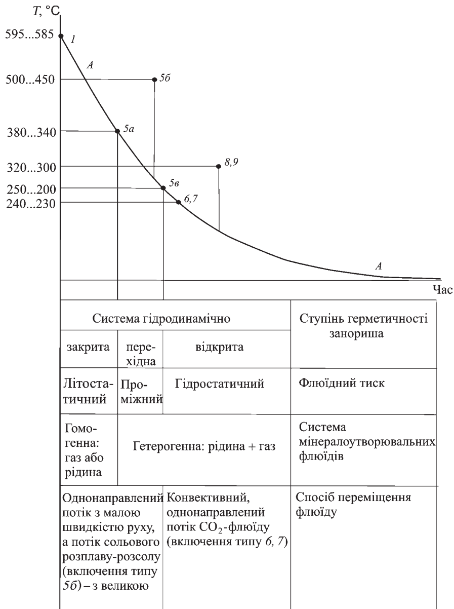
Рис. 4. Схема зміни параметрів мінералоутворювальних флюїдів з часом у період росту кристалів у заноришах продуктивних пегматитових тіл Волині, за результатами вивчення включень у кварці. 1, 5а, 5б, 5в, 6, 7, 8, 9 — типи флюїдних включень [9], крива AA — температурна крива остигання тіла
