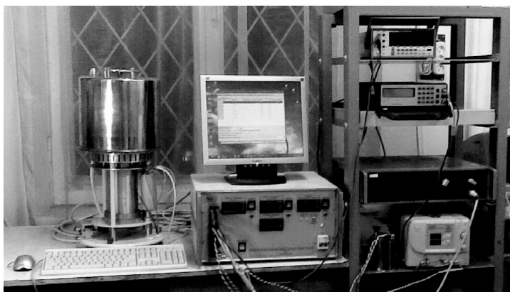
Рис. 1. Внешний вид эталонной измерительной установки УВТ-1.
