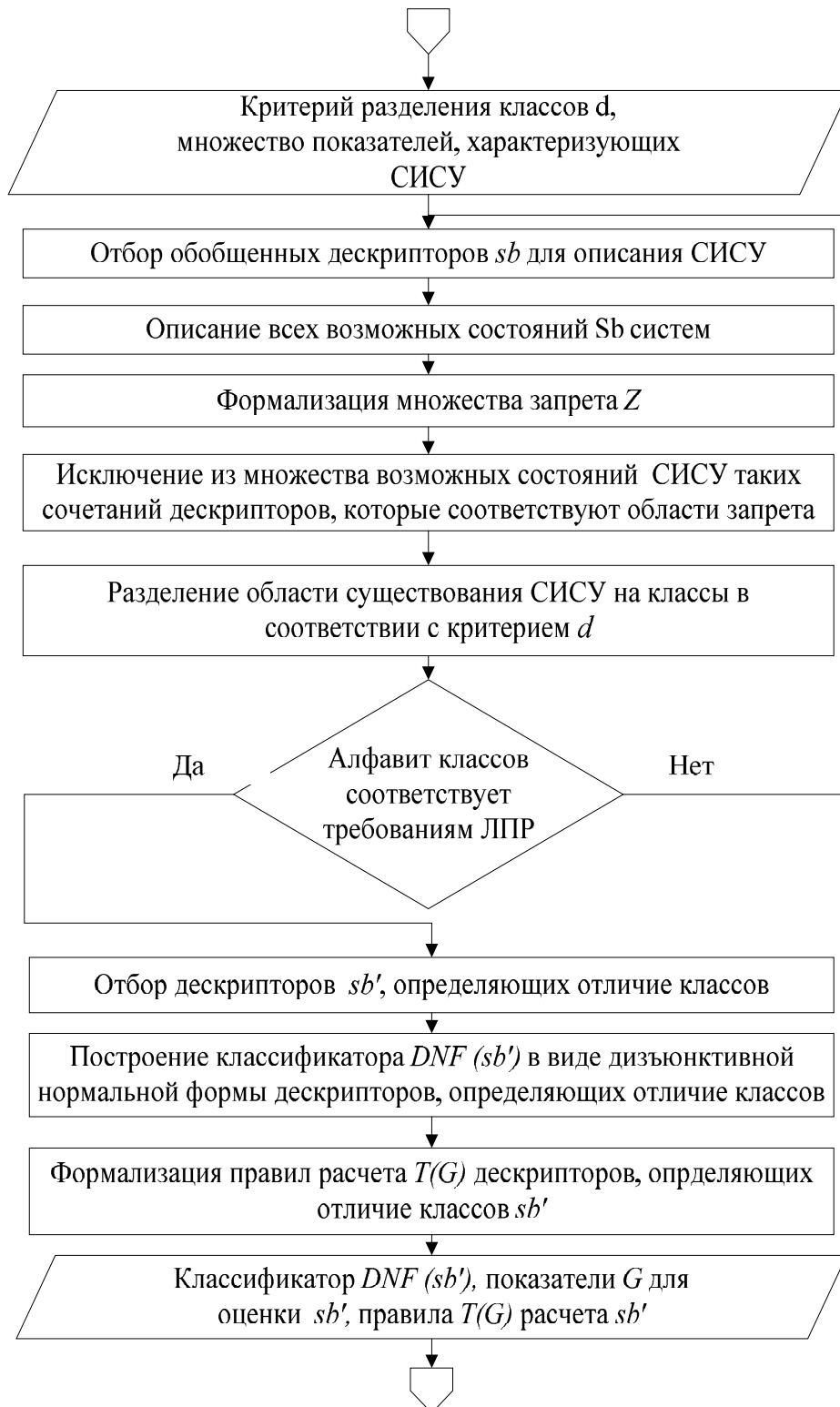
Рисунок 1 – Графическая схема алгоритма метода классификации без учителя на основе неколичественно заданного критерия разделения классов
