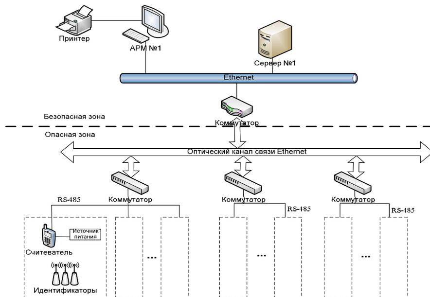
Рисунок 1 – Структура системы наблюдения и поиска горнорабочих в шахте
