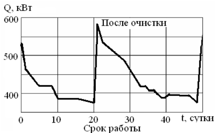
Рис. 7. Изменение теплопроизводительности ТВМ в процессе эксплуатации.
