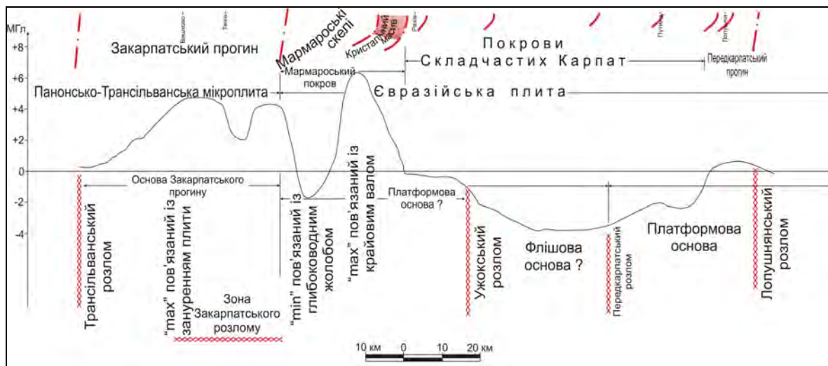
Рис. 2. Профіль локальних аномалій сили тяжіння по лінії Тячів-Рахів-Путила-Лопушна
