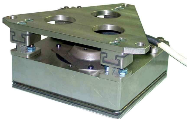
Гидроакустическая приемо-передающая антенна для рабочих глубин до 6000 м. Габариты 180x200x103 мм, вес 10 кг при длине кабеля 20 м, а) общий вид; б) вид на рабочую поверхность
