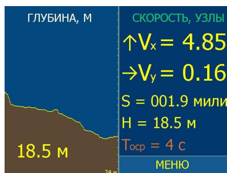
Информация на экране прибора отображения лага ЛДУ
