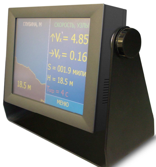
Прибор отображения и архивирования на основе ТРС-660. Габариты 195x148x45мм
