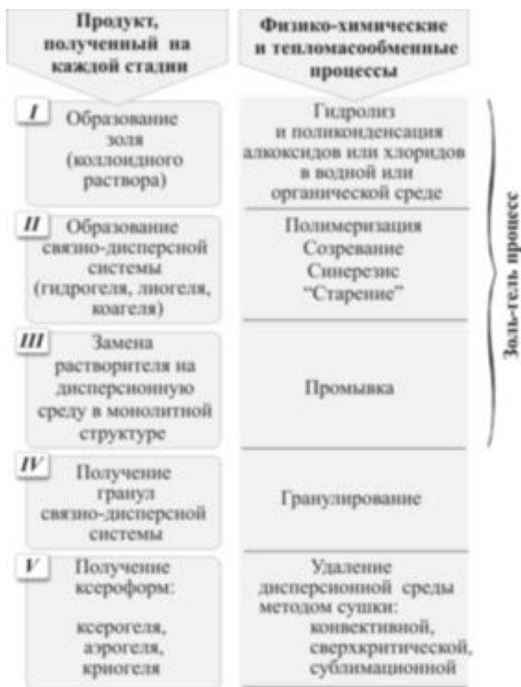
Рис. 2. Поэтапная схема получения ксерогелей.
