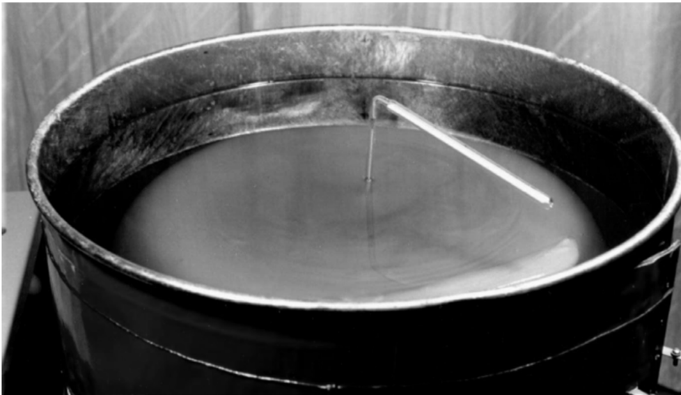
Рис. 3. Фото протікання процесу плавлення вазеліну в ємності з використанням стрічкових електронагрівачів.
