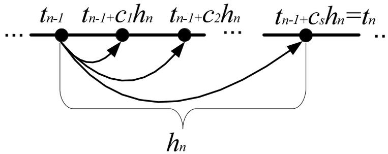
Рисунок 2 – Шаблон  $s$  – стадийного параллельного метода
