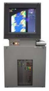
Прибор 16 — комбинированный прибор формирования и обработки сигналов, связи с внешними системами, единый пульт управления и отображения информации.
