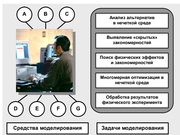
Рисунок 1 – Информационная среда анализа и интерпретации проектных решений: последовательность А – G определяет цикл задач конструктора: А – формулировка задачи; В – установка параметров; С – помещение задачи в очередь на выполнение; D – решение задачи; E – анализ результатов; F – представление результатов; G – удаление задачи
