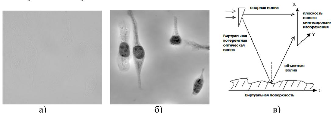
Рисунок 1 – Сопоставление результатов обычной (а) и фазоконтрастной (б) микроскопии, схема метода виртуальной голографической интерферометрии (в)
