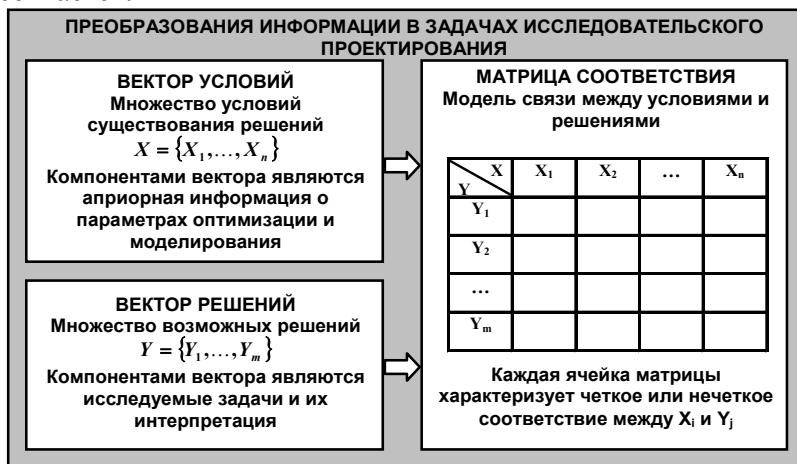
Рисунок 7 – Модель преобразования информации при анализе трудно формализуемых задач
