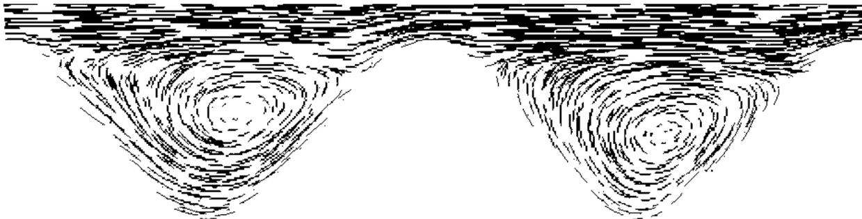
**Рис. 7.** Распределение векторов скорости в аксиальном сечении винтообразной трубы с  $h = 7$  мм;  $t = 12$  мм;  $r = 1,6$  мм при  $Re = 4,6 \cdot 10^4$ .
