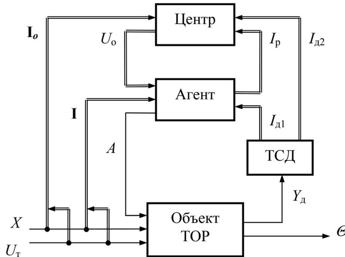
Рисунок 4 – Базовая структура организационной системы управления техническим состоянием
