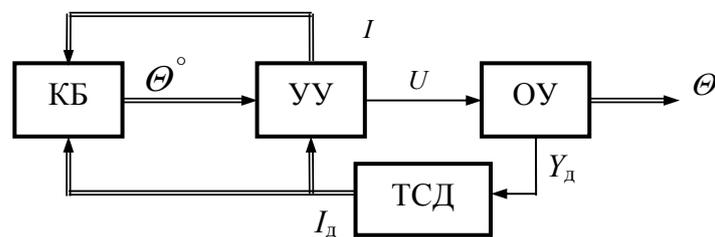
Рисунок 3 – Структурная схема СУТС
