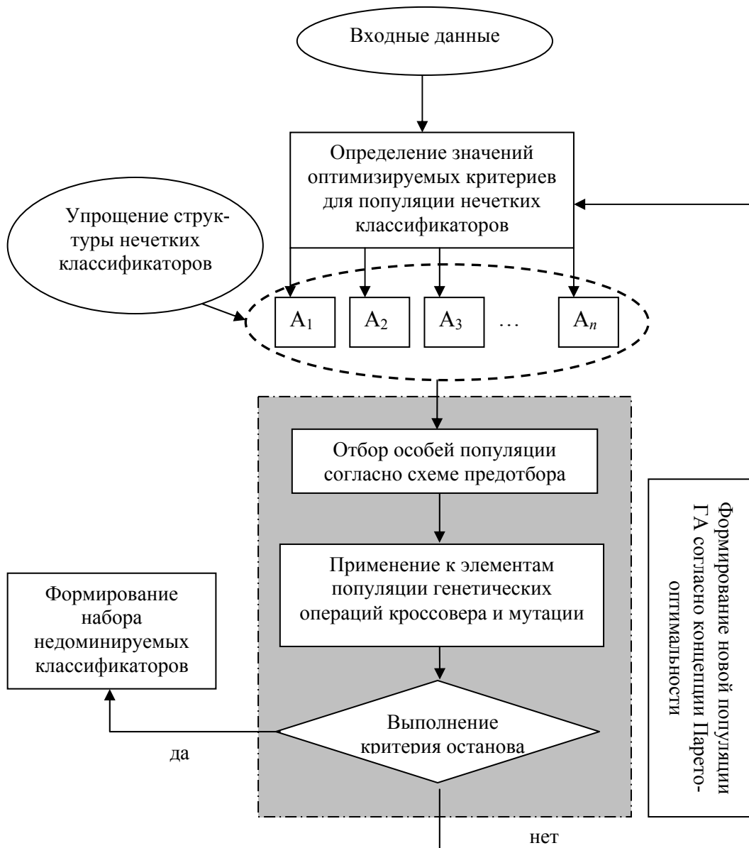
Рисунок 1 – Общая схема работы алгоритма обучения нечеткого классификатора с использованием генетических процедур
