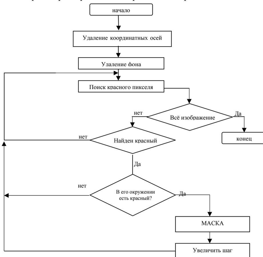
Рисунок 3 – Алгоритм предварительной обработки
