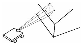
Рисунок 1 — По положению следов четырех зондирующих лучей на удаленном препятствии (зарегистрированных бортовой камерой на фото/видеоизображении) можно вычислить удаленность и ориентацию по двум углам участка препятствия, аппроксимированного двумя треугольниками, изображенными пунктирными линиями
