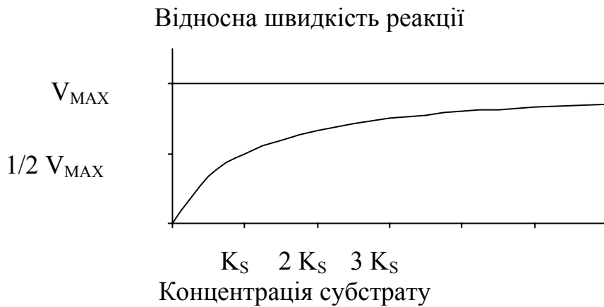
Рис. 2. Графік залежності швидкості реакції від концентрації субстрату в рівнянні Міхаеліса-Ментен (для ферментативних реакцій у біологічних системах) за [23]
