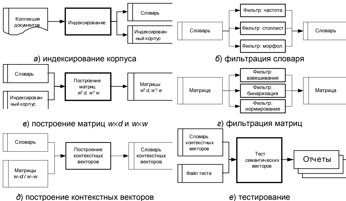
Рис. 1. Последовательность вызовов программ построения контекстных векторов
