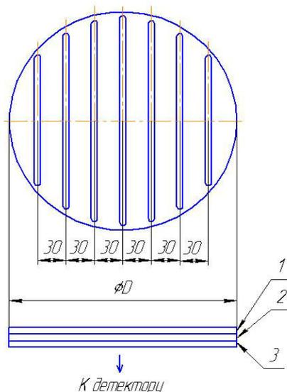
1 – алюминиевый сплав 3 мм; 2 – свинец 3 мм; 3 – алюминиевый сплав 0,5 мм
