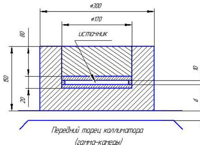
Рисунок 3 – Цилиндрический фантом для измерения системной чувствительности и скорости счета
