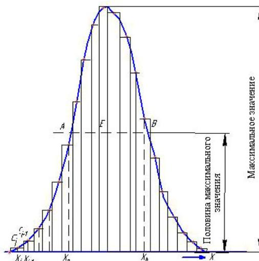
Рисунок 1 – Измерение полной ширины на уровне половины максимума
