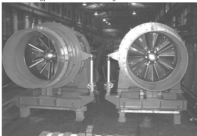
Турбины Т-90 для Яблуницької ГЭС в цеху
