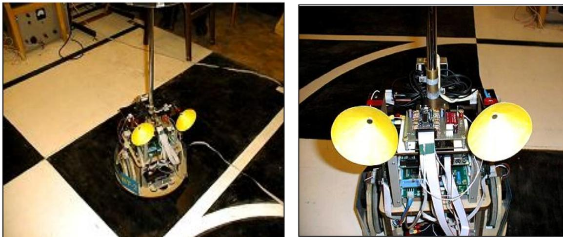
Рисунок 1 – Робот «Аргонавт-2» с системой слуха
