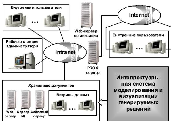
Рисунок 5 – Взаимодействие ИС исследовательского проектирования с хранилищем данных
