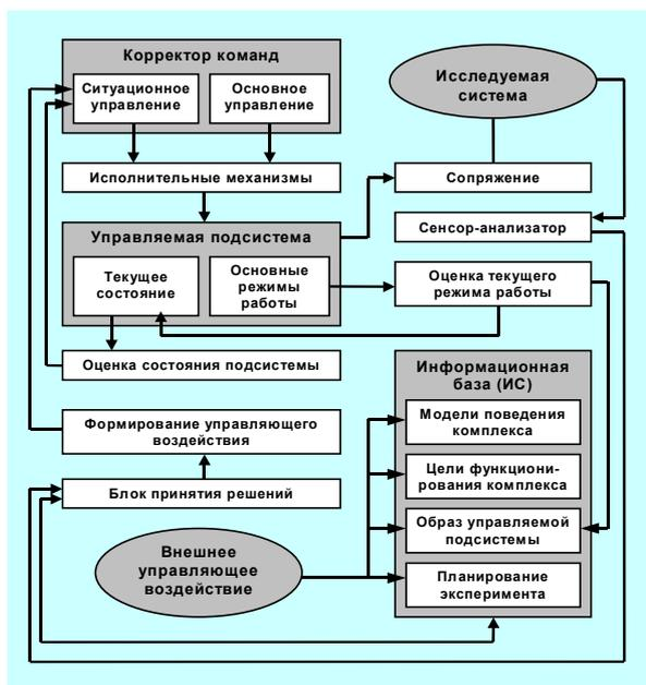
Рисунок 2 – Цикл управления интеллектуального комплекса физико-математического моделирования
