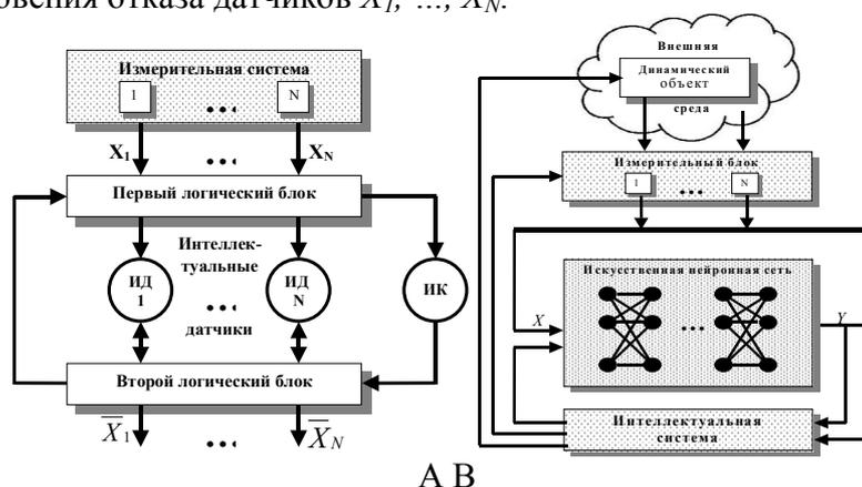
Рисунок 7 – Схема отказоустойчивой измерительной системы (А); ИС управления динамическим объектом с интеллектуальным датчиком (В)
