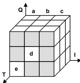
Рисунок 6 – Гиперкуб данных: a, b, c – метки; e, d – пустые ячейки
