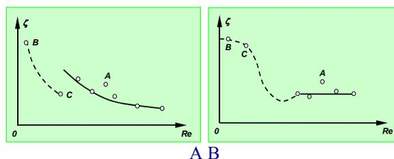
Рисунок 3 – Кривые изменения коэффициента сопротивления в зависимости от числа Рейнольдса: А – глубоко погруженная пластина; В – шар, цилиндр
