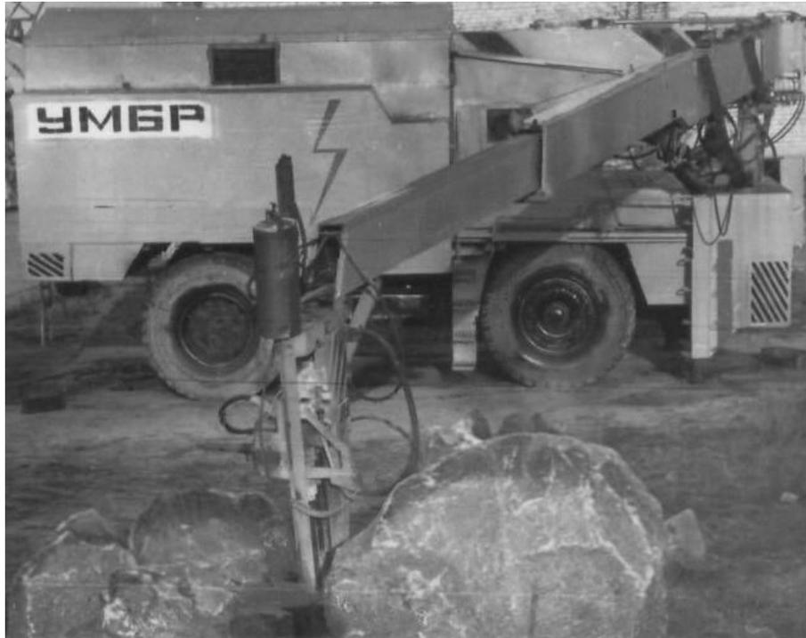
Рисунок 2 – Установка механизации бурения и разрушения негабаритов
