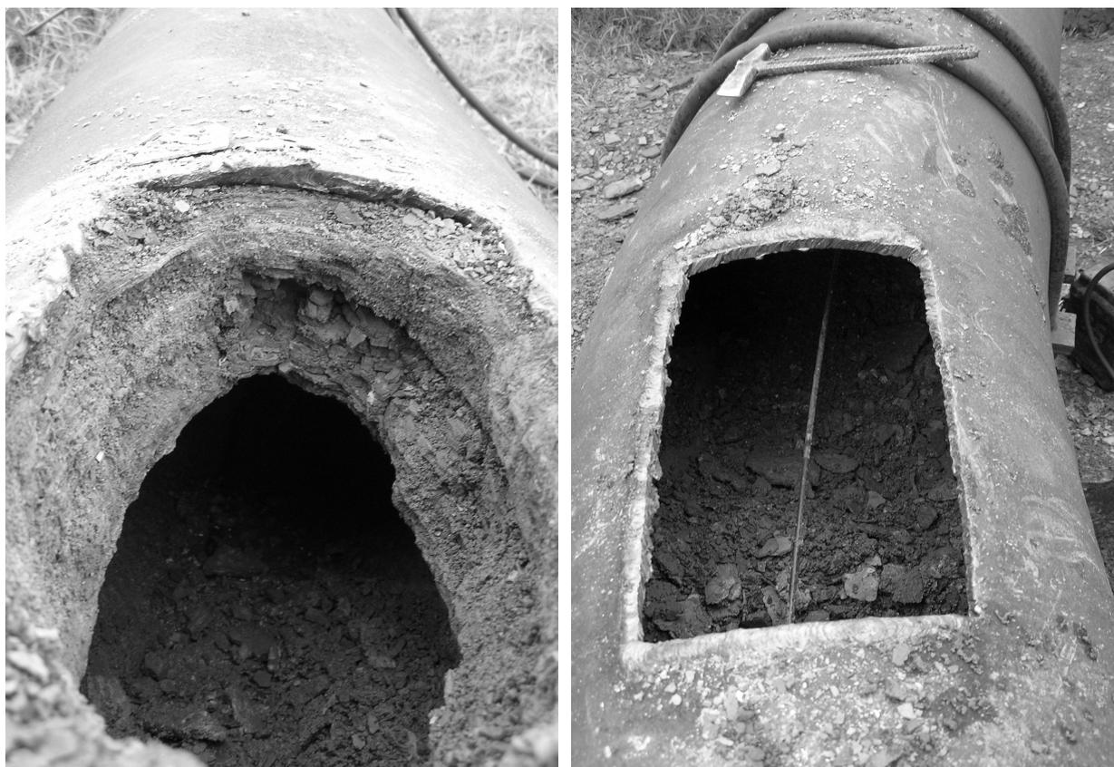
Рисунок 4 – Труба коллектора теплоцентрали до и после очистки
