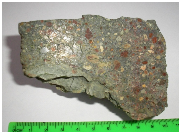
Рис. 7. Автолит-пизолит-лапиллиевая ксенотуфобрекчия. Общий вид (скв. 4055, глубина отбора 85,1-85,3 м). Участок Лесной
