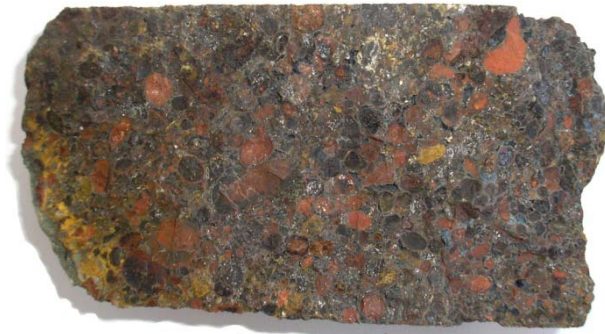
Рис. 8. Автолитовая ксенотуфобрекчия кимберлита, ожелезненная. Общий вид (скв. 4067, гл. 103,8-104,15 м). Участок Лесной
