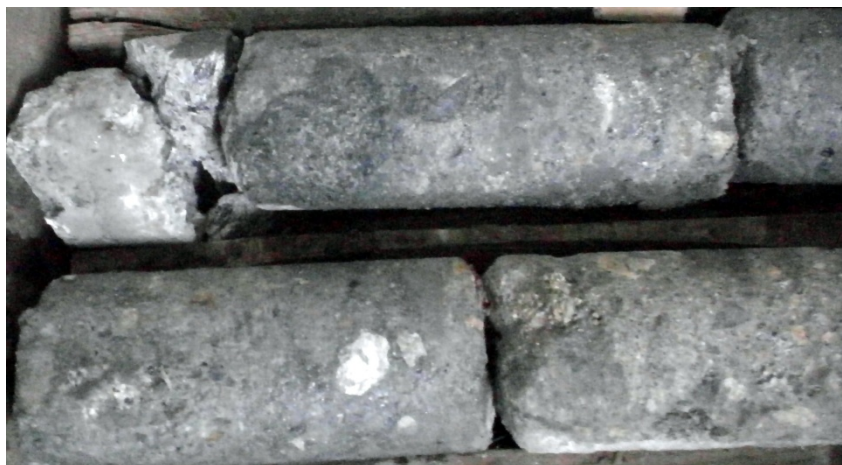
Рис. 12. Ксенотуфобрекчия с ксенолитами автолитовой кимберлитовой брекчий. Участок Зеленогайский. Скважина 3999. Фрагмент интервала керн 349,5-351,6 м
