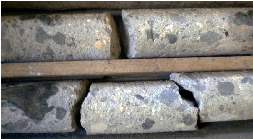
Рис. 11. Ксенотуфобрекчия с ксенолитами автолитовой кимберлитовой брекчий. Участок Зеленогайский. Скважина 3999. Фрагмент интервала керн 294,3-295,6 м
