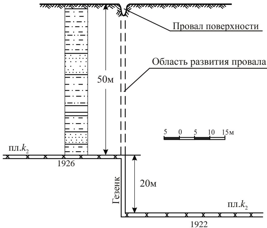
Рис. 5. Провал поверхности над гезенком шахты «Червона Зирка» ПО «Торезантрацит»
