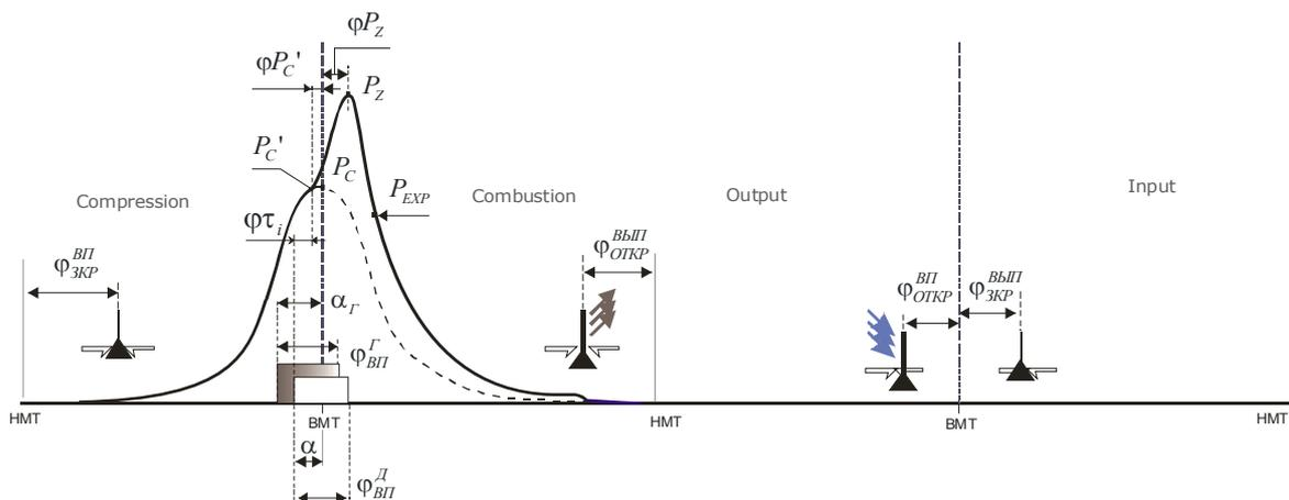
Рисунок 1 – Параметры рабочего процесса, топливоподачи и газораспределения, определяемые системой диагностики рабочего процесса СДВС
