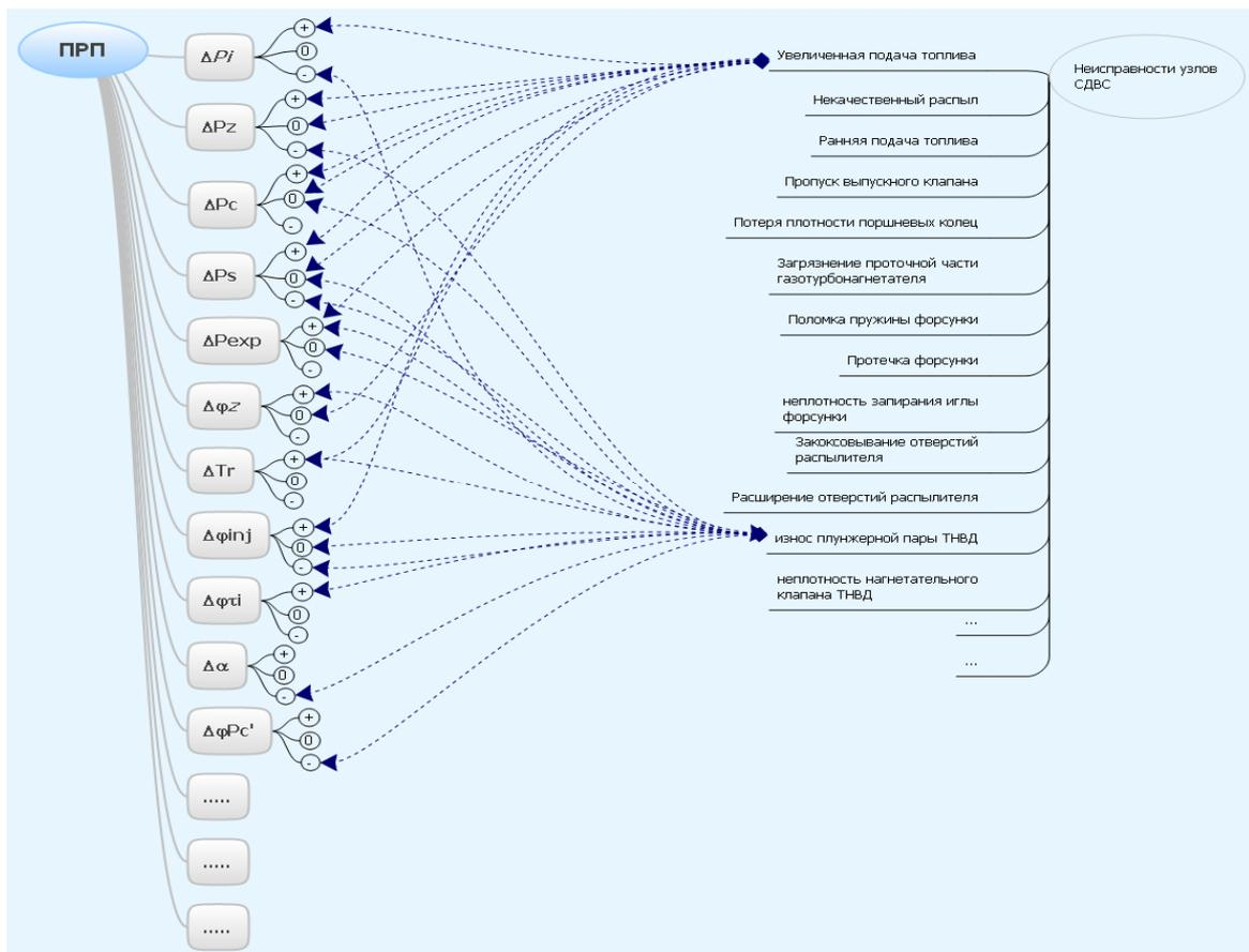
Рисунок 2 – Пример характерных неисправностей СДВС и соответствующих им изменений параметров рабочего процесса
