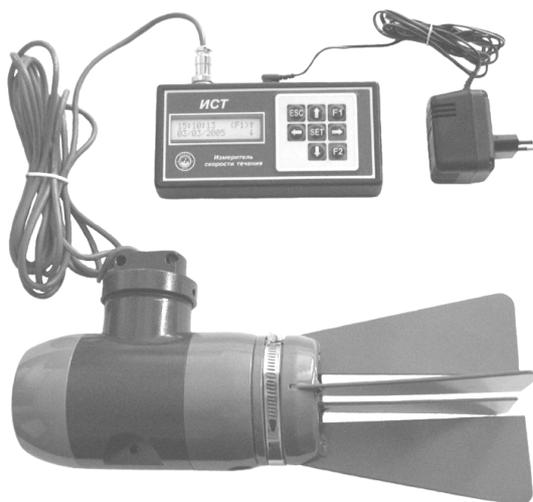
**Р и с. 1.** Внешний вид погружного и бортового блоков ИСТ-1М
