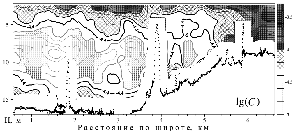
Р и с. 10. Распределение логарифма концентрации взвеси (жирная сплошная линия соответствует концентрации 0,04 мг/л, темные области – концентрациям более 0,1 мг/л)
