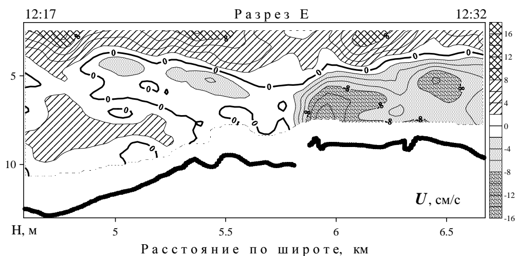
Р и с. 7. Распределение скорости течений на разрезе Е (обозначения, как на рис. 3)
