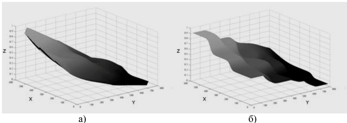
Рисунок 2 – Интерполяция модельного поля: а) – методом на основе триангуляции Делоне; б) – методом двумерного проецирования нечетких кластеров
