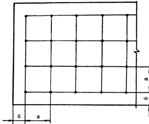
Рисунок 1 – Схема прямоугольного размещения датчиков
