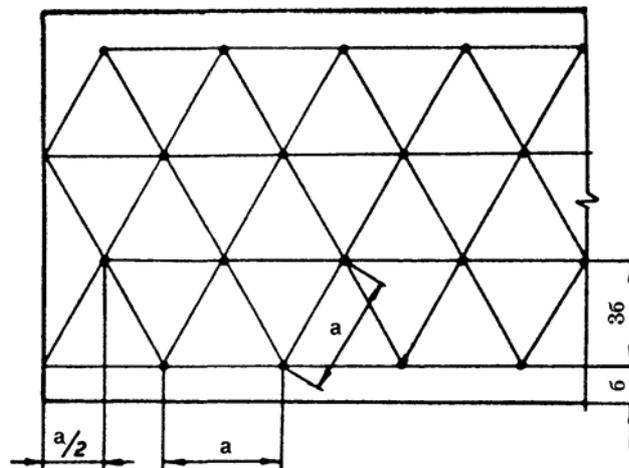
Рисунок 2 – Схема треугольного размещения датчиков
