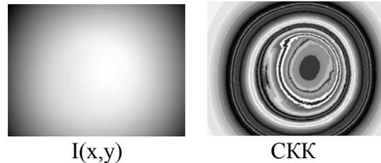
Рисунок 5 – Результат сегментации изображения оптического излучения из конца волоконно-оптического кабеля
