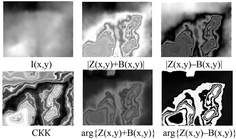
Рисунок 2 – Сегментация изображения электрического потенциального поля  $I(x,y)$  участка Земной поверхности
