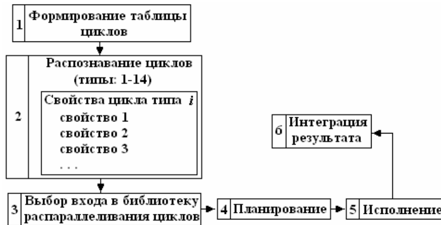
Рисунок 3 – Алгоритм обработки циклов
