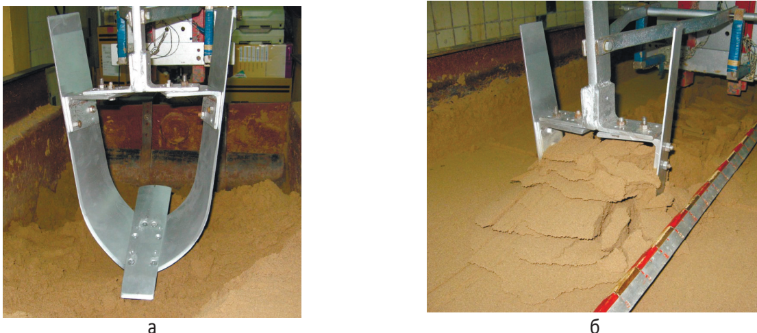
а – модель скоби; б – робочий момент взаємодії моделі з ґрунтом
