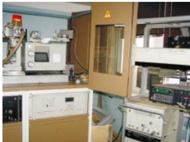
Разработанный в институте диффрактометр для измерения рентгено-акустического резонанса
