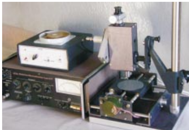
Разработанный в институте сверхчувствительный лазерный тензомер
