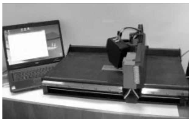
Рис. 3. Система трехмерных измерений размеров микросборок ПЗС «Трианмикро»
