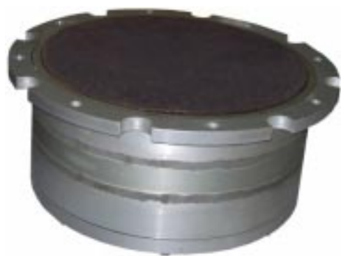
Рис. 1. Принципиальная схема высокочастотного ИИ с односеточной ИОС и его фото
