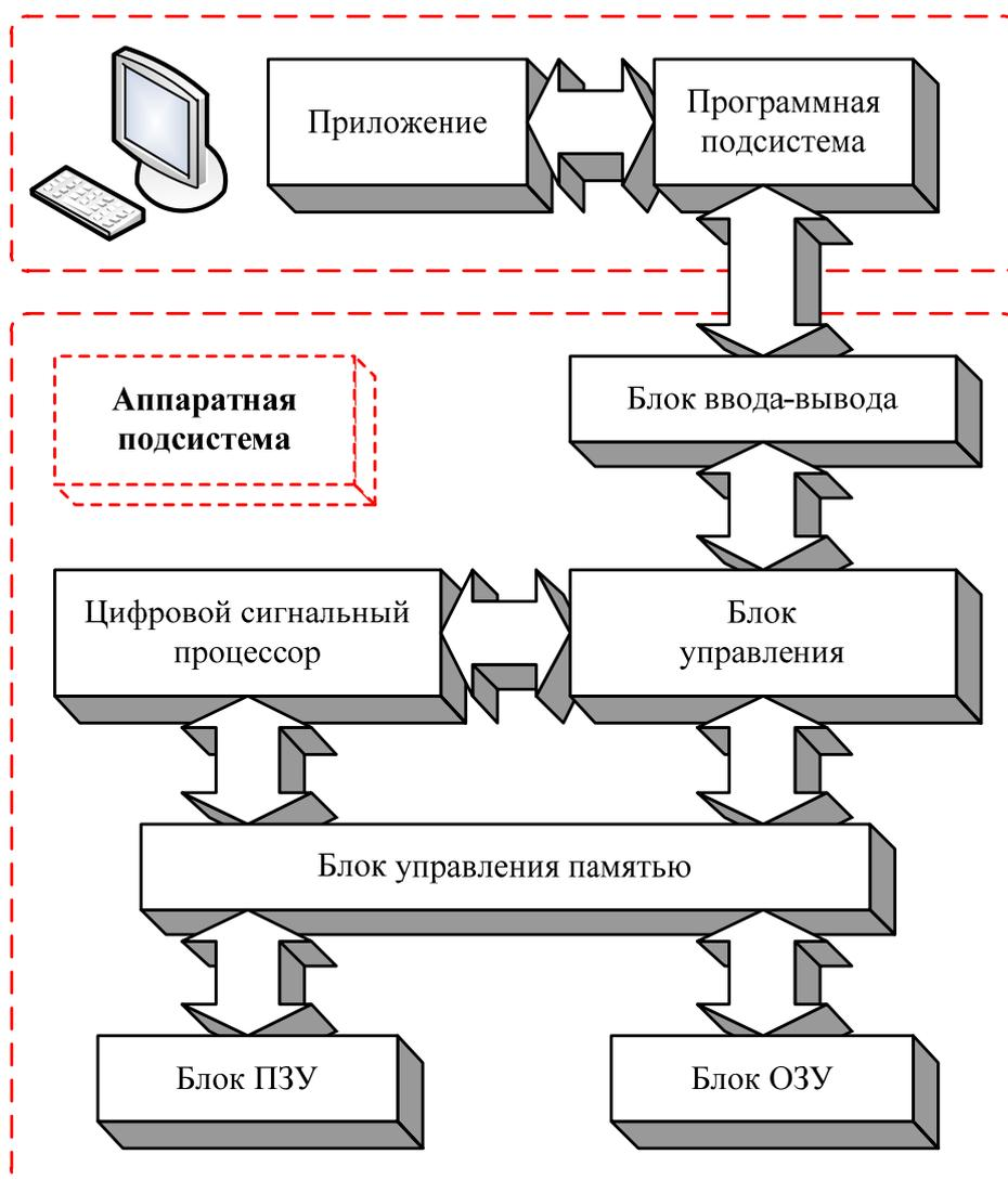
Рис. 3. Принципиальная схема устройства на базе ПЦОС
