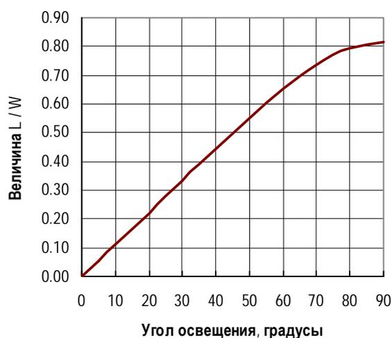
Рис. 2. Соотношение между  $L$  и  $W$ , при котором коэффициент активной апертуры  $S/S^* = 100\%$  для системы «поликарбонат–воздух»
