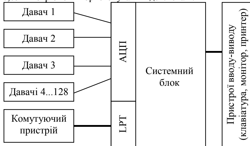
Рис. 1. Структурна схема віртуального вимірювального комплексу для дослідження перехідних процесів в електричних колах довільної конфігурації
