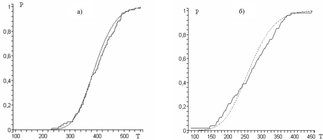
Рис. 3. Зависимости вероятностей отказа компонентов от количества циклов нагружения: а) полученные экспериментально; б) с использованием моделирования
