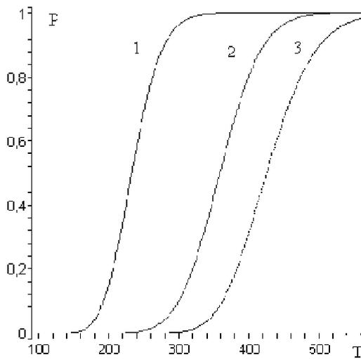
Рис. 4. Графики вероятностей отказа системы в зависимости от количества циклов нагружения при различных функциях взаимодействия компонентов системы: 1 —  $F_3(i, j) = \min(i + j - 1, n)$ ; 2 —  $F_1(i, j) = \max(i, j)$ ; 3 —  $F_2(i, j) = \min(i, j)$
