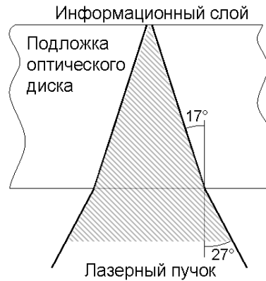
Рис. 1. Фокусирование лазерного луча на информационном слое компакт-диска
