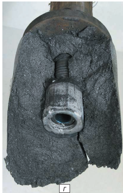
Рис. 6. Динамика развития трещины в теле огнеупорного элемента стопорной системы
