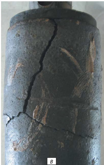
Рис. 6. Динамика развития трещины в теле огнеупорного элемента стопорной системы
