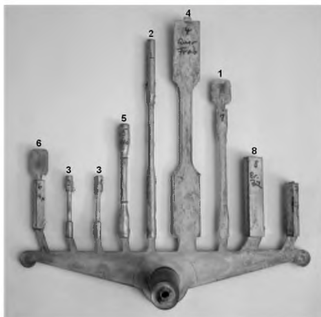
Рис. 1. Образцы для исследования, изготовленные по стандартам DIN 50148, EN ISO 12737.
