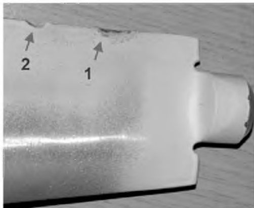
Рис. 1. Коррозионно-усталостное разрушение поверхности лопатки из стали 14X17H2 в процессе эксплуатации (1) и хрупкое разрушение в области заборин при аварийном разрушении (2).
